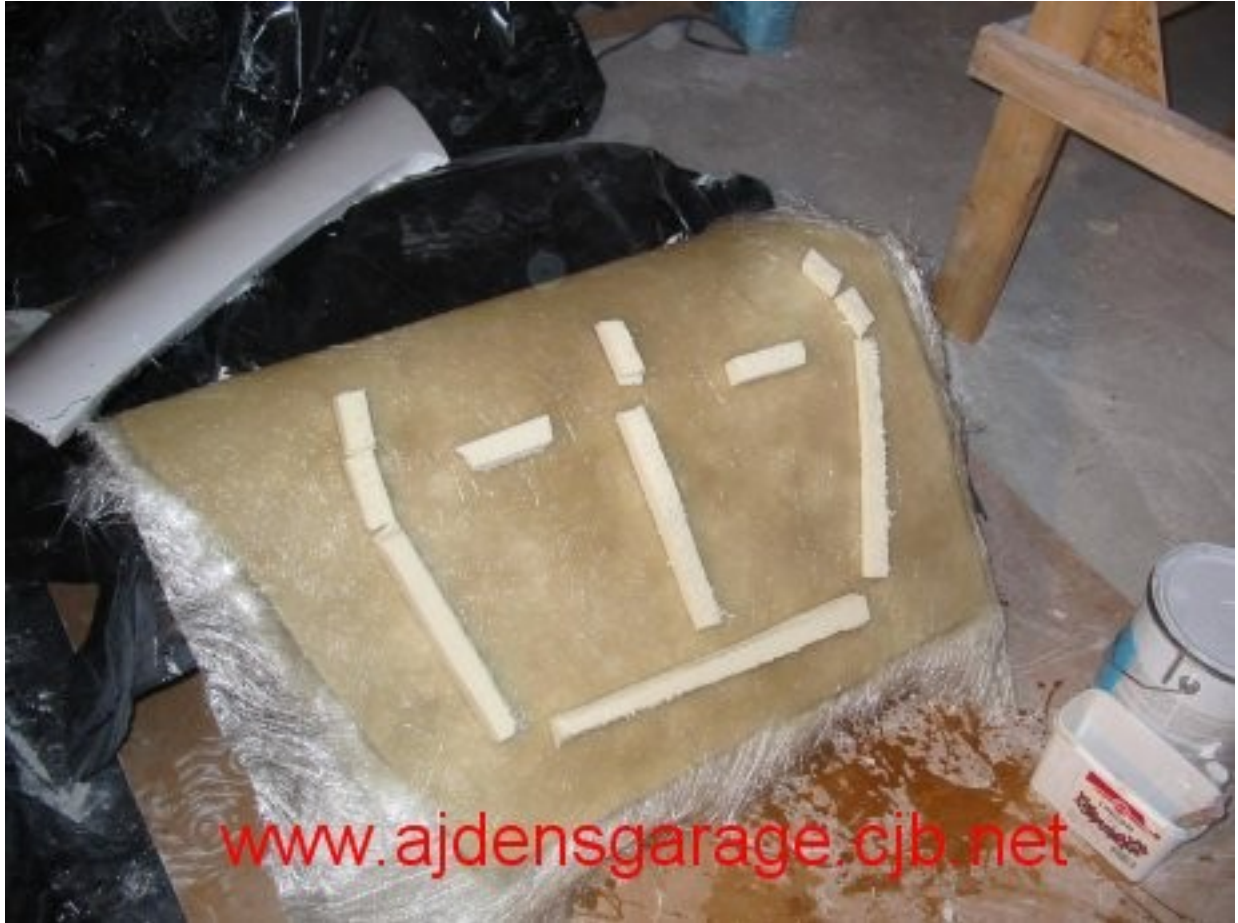
4 lager glasfiber och Bonocell bitar som ska gjutas in.
