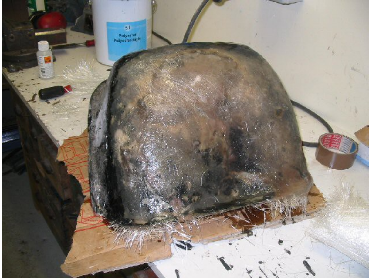
3. Lägg på 2 lager glasfiber. Låt torka.
